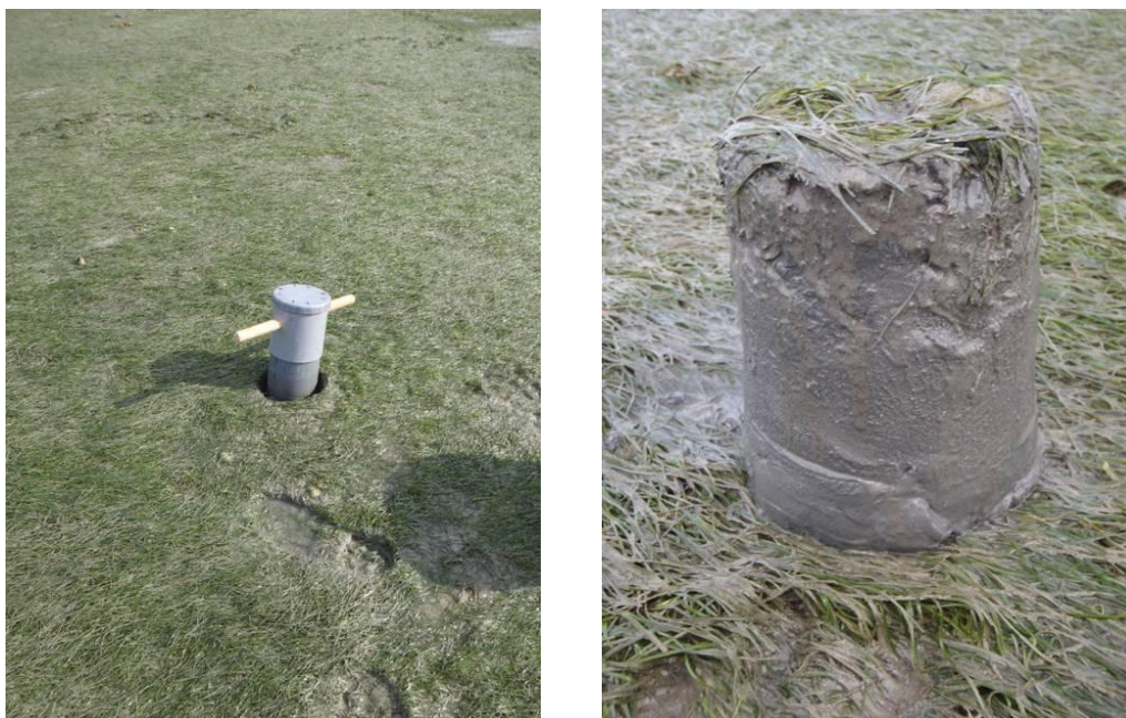
Figure 1 : Carottier à main et carotte obtenue dans l'herbier de Zostera noltii . (Cliché TBM)
