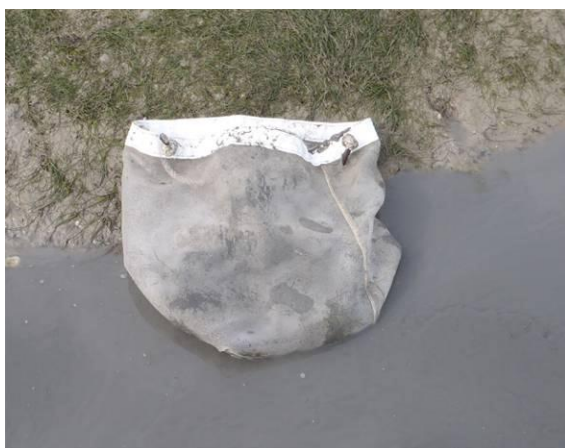
Figure 2 : Tamis de maille de 1 mm utilisé pour laver les carottes (Cliché TBM)
