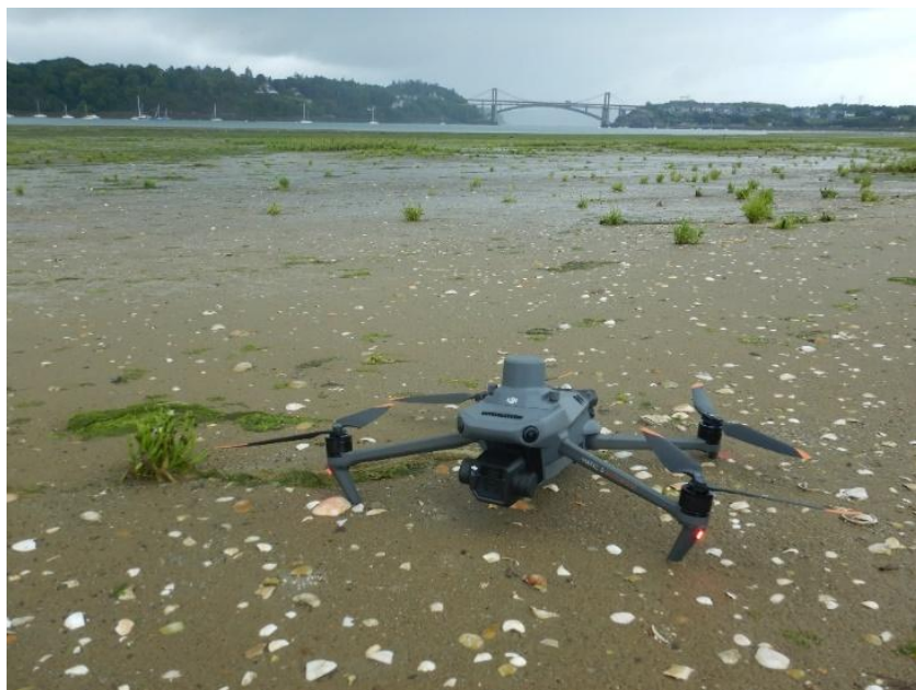
Figure 12. Drone Dji Mavic 3 Enterprise connecté à son antenne RTK en Rance
